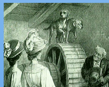
Chiens utilisés pour la roue d'une pompe à eau.
