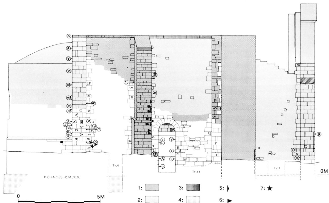
Fig. 9 : Elévation externe du mur goutterot nord. 1 - Restaurations, adjonctions anciennes. 2 - Restaurations de 1946-53. 3 - Moellons neufs. 4 - Fondations. 5 - Moellons resurfacés à la gradine. 6 - Assises comportant un joint à 0,90 m de l'angle. 7 - Moellons surfacés au marteau taillant bretté.
